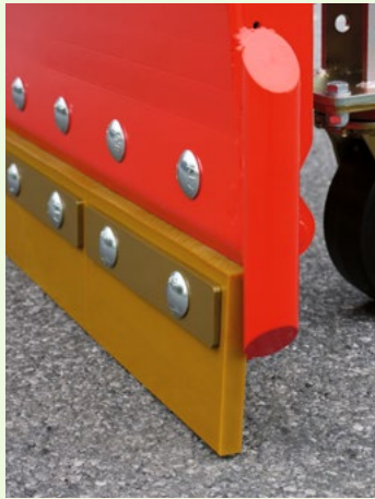
Vereisungsfreie Federklappen auch beim neuen Schneeschild der SL-Serie
