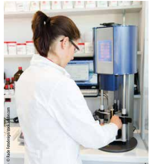
300 bis 3.000 Umdrehungen pro Minute und hygienische Herstellung von Rezepturen – Salben werden schon seit Jahrzehnten nicht mehr mit der Hand gerührt, sondern mit Salbenmischgeräten in den Apothekenlaboren hergestellt.
