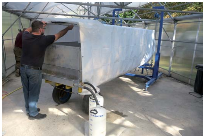
Versuchsanordnung für Durchflussmessungen bei versickerungsoffenen Belägen im Lehr- und Forschungsgarten (links, Bautechnik in der Landschaftsarchitektur, Prof. Dr. Thon) und Beregnungsanlage für Abflussbeiwertmessungen bei Dachbegrünungen und auf Tiefgaragenbegrünungen am Institut für Landschaftsbau und Vegetationstechnik (rechts, Vegetationstechnik im Landschaftsbau, Prof. Westerholt).
