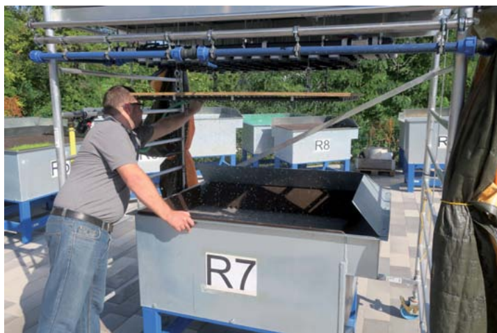
Versuchsanordnung für Durchflussmessungen bei versickerungsoffenen Belägen im Lehr- und Forschungsgarten (links, Bautechnik in der Landschaftsarchitektur, Prof. Dr. Thon) und Beregnungsanlage für Abflussbeiwertmessungen bei Dachbegrünungen und auf Tiefgaragenbegrünungen am Institut für Landschaftsbau und Vegetationstechnik (rechts, Vegetationstechnik im Landschaftsbau, Prof. Westerholt).
